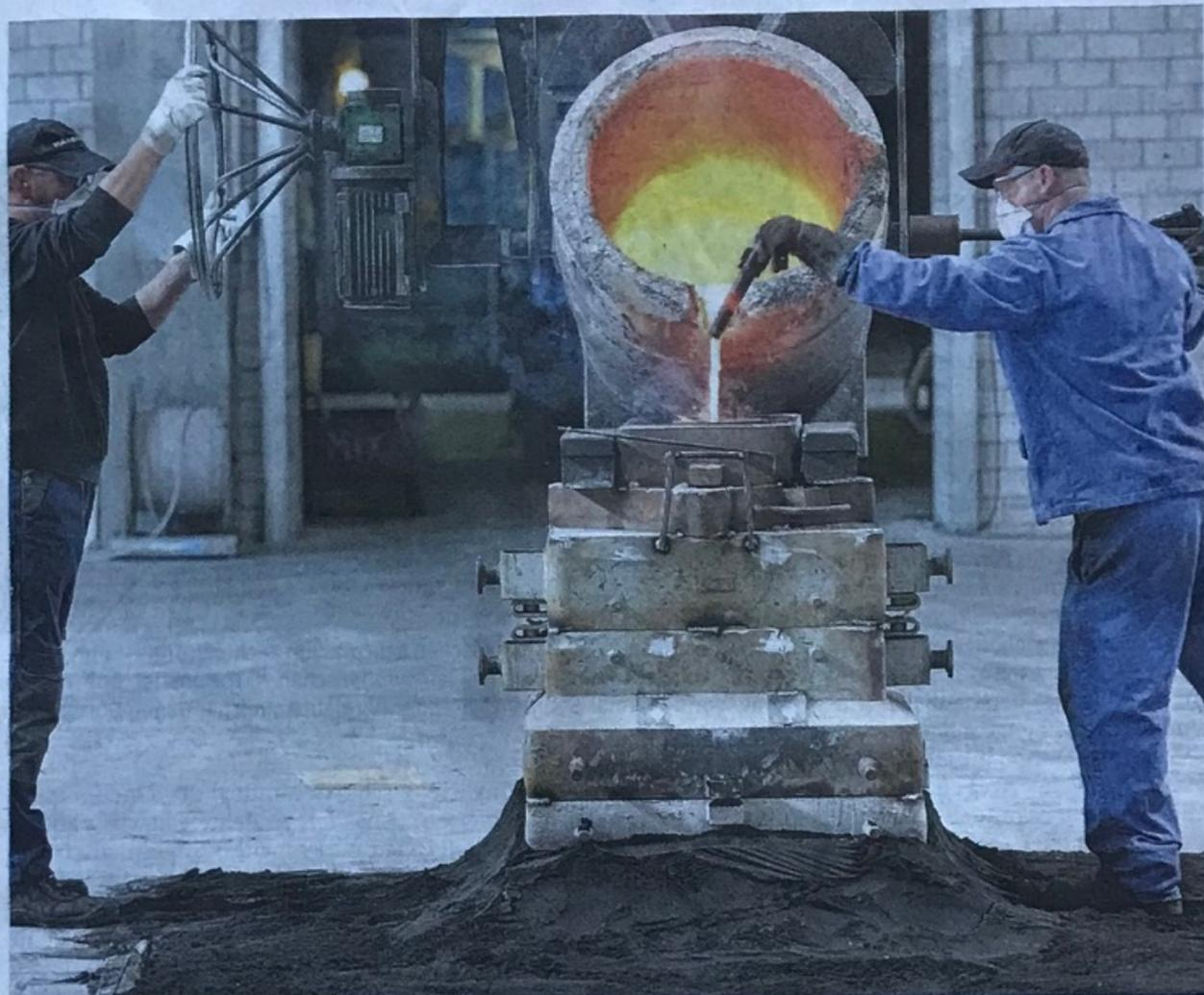
Eine neue Glocke ist jetzt im Sächsischen Metallwerk an der Zuger Straße in Freiberg gegossen worden.
