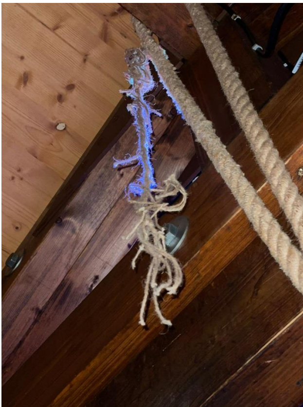
Das Seil ist gerissen, das Läuten muss abgebrochen werden, Foto: Kathrin Teubel
