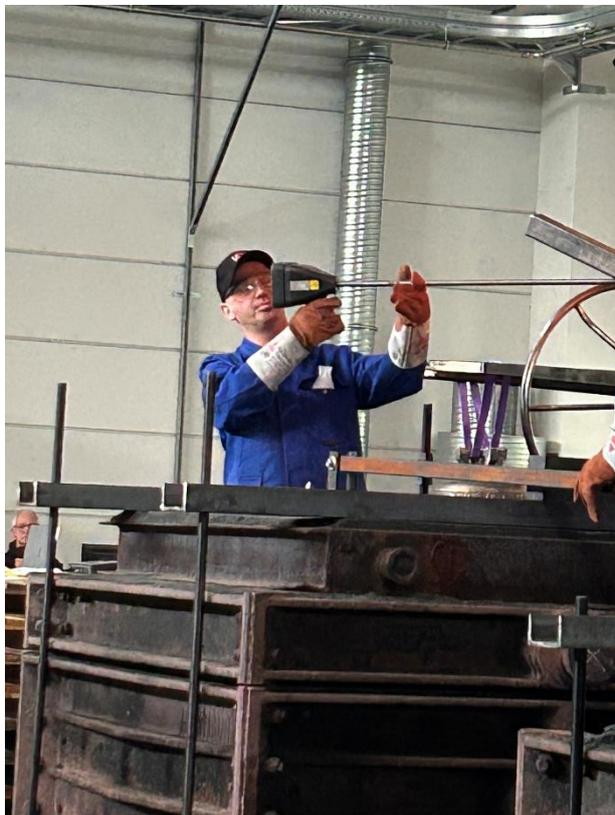
Bild 4 Der Gießer stellt die Temperatur der Schmelze fest, Foto: Knut Neumann
