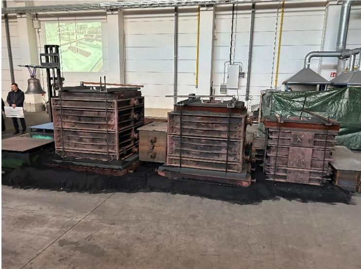
Bild 1 Die drei eingepackten Glockenformen stehen für den Guss bereit, Foto Knut Neumann
