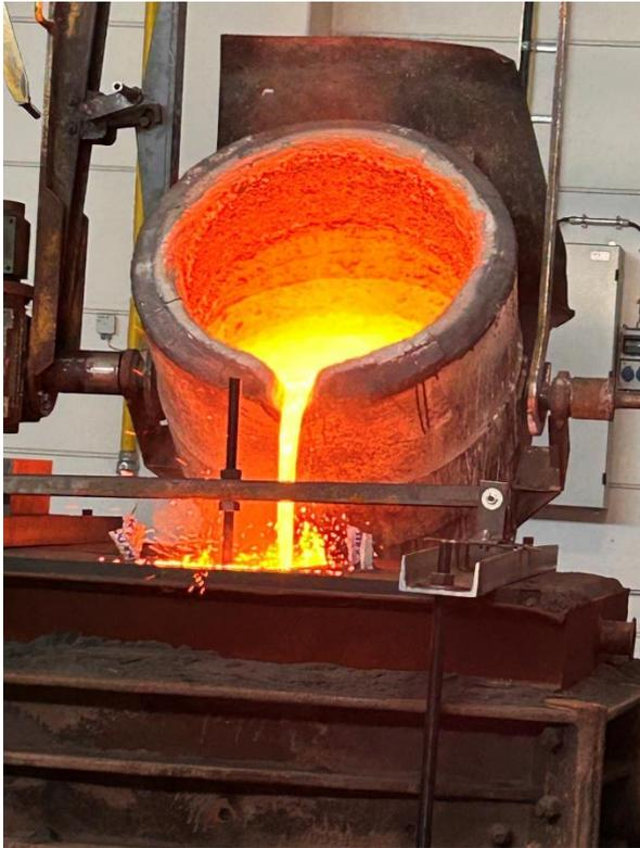
Bild 5 Die Schmelze fließt in die Form,
