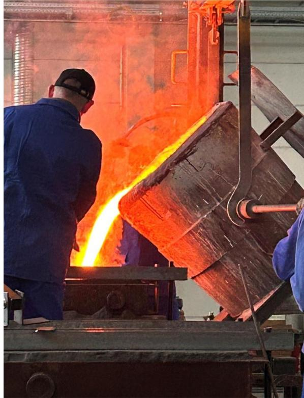
Bild 6 Guss der großen Glocke, Fotos: Knut Neumann
